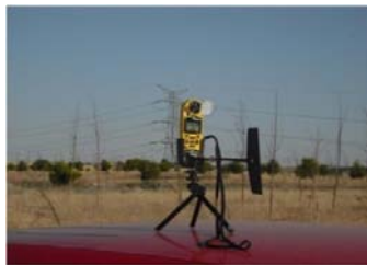
Figura 23. Estación meteorológica portátil Kestrel 4500
