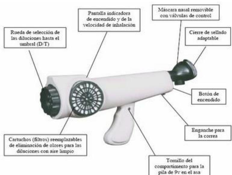
Figura 3. Diagrama de los componentes principales del Nasal Ranger™
