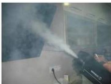
**Figura 7. Detalle de la prueba de humo en la cocina del cuarto-puerta 2**
